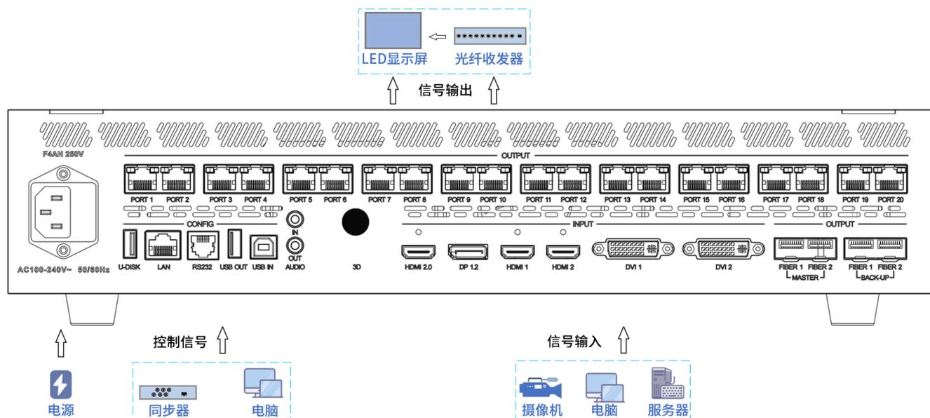
网口输出：选择网口输出时，网口通过网线直接连接至 LED 显示屏。
