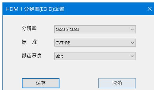
点击下拉按钮，会显示分辨率列表。在发送器里面可选择常规分辨率，也可自定义设置发送器分辨率。选择自定义分辨率时，可自定义设置分辨率的宽高、帧率和标准。
